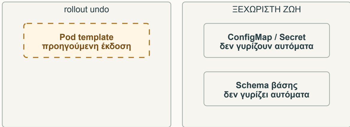
Σχήμα 9.4 · Το undo αφορά το Pod template του Deployment. Ρυθμίσεις και δεδομένα χρειάζονται δικό τους σχέδιο επαναφοράς.
