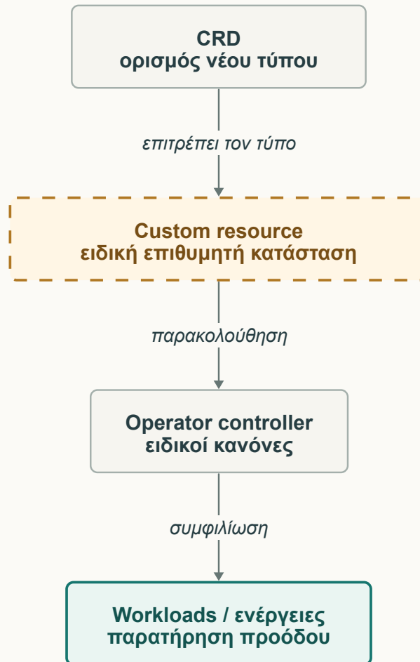
Σχήμα 24.2 · Ο operator προσθέτει ειδική γνώση πάνω στο ίδιο API. Η εγκατάσταση ενός CRD ορίζει τον νέο τύπο. Ο controller είναι εκείνος που εφαρμόζει τη συμπεριφορά.
