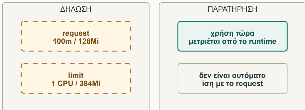
Σχήμα 16.1 · Το request είναι δήλωση για τοποθέτηση. Η κατανάλωση μετριέται κατά την εκτέλεση. Το limit είναι όριο που επιβάλλεται από το runtime και το λειτουργικό σύστημα.
