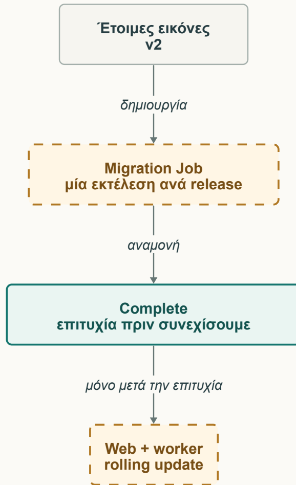
Σχήμα 14.2 · Το release περιμένει να ολοκληρωθεί το Job πριν ενημερώσει τα Deployments. Η αποτυχία του migration σταματά τη διαδρομή πριν από το web και τον worker.
