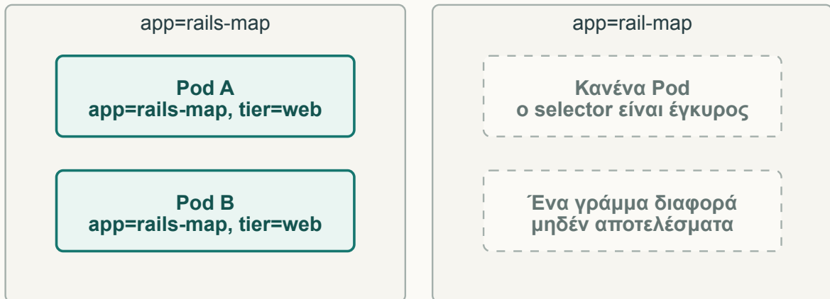
Σχήμα 8.1 · Τα ίδια Pods, δύο ερωτήματα. Ο σωστός selector βρίσκει δύο. Το μικρό τυπογραφικό λάθος βρίσκει μηδέν.
