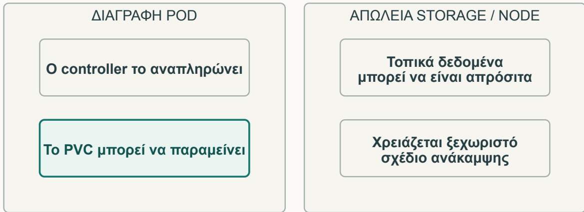
Σχήμα 13.3 · Η επιβίωση μετά τη διαγραφή Pod είναι ένα συγκεκριμένο τεστ. Η απώλεια του node ή του αποθηκευτικού μέσου είναι διαφορετικό τεστ.
